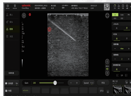
Auto Needle automatyczne wykrywanie igły i automatyczna regulacja wiązki akustycznej
